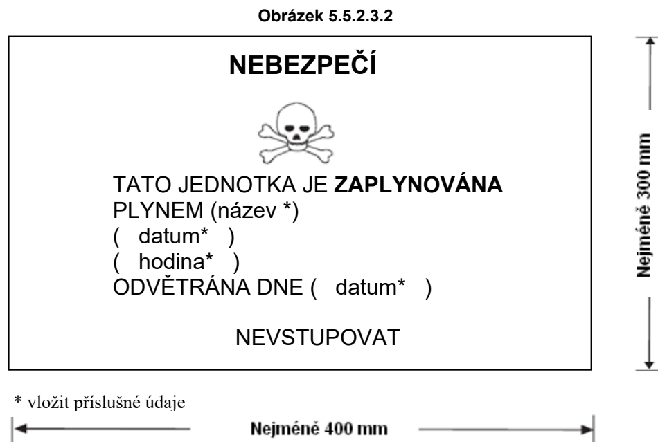
Výstražná značka pro zaplynovanou jednotku
